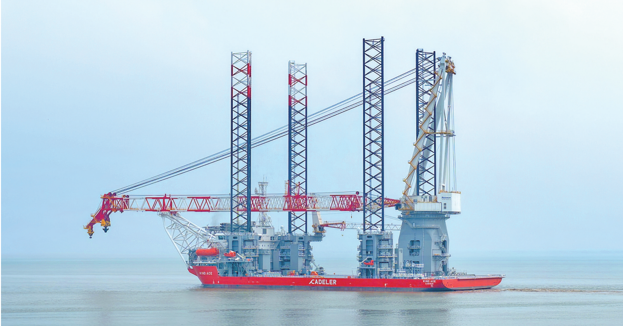
日前,启东中远海运海工为丹麦船东定制的NG20000型风电安装船“峰盛”号正式交付启航。该船拥有超过5600平方米超大甲板、17600吨有效载荷、大于3300吨主吊起重能力,可精准安装20兆瓦级以上超大型风机。 新华社发(许丛军 摄)
