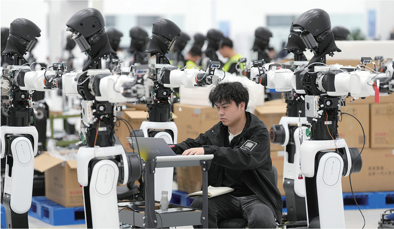
从关键技术突破到应用场景落地,从单点创新发力到全链条系统协同,在建设创新型省份和科技强省的战略指引下,浙江科技创新实现跨越式发展,不断塑造发展新动能新优势。图为技术人员在宁波普智未来机器人有限公司组装人形机器人。
