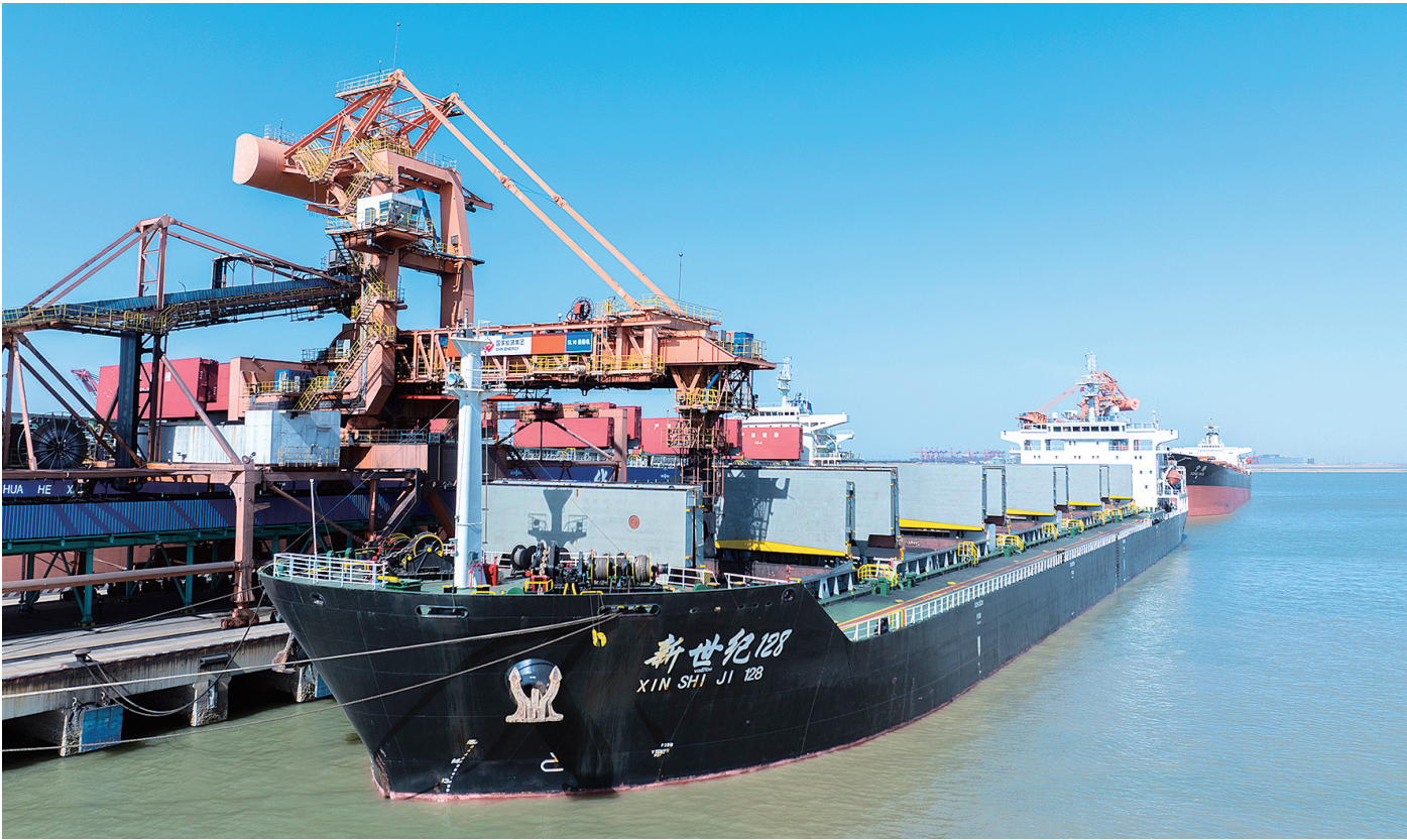
黄骅港务装船码头上，装船机正将煤炭装入船舱。
