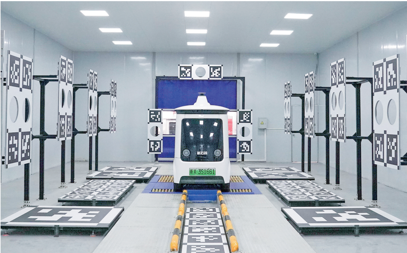
在新石器(盐城)智能制造有限公司无人车生产线,一辆无人车在进行调试。
