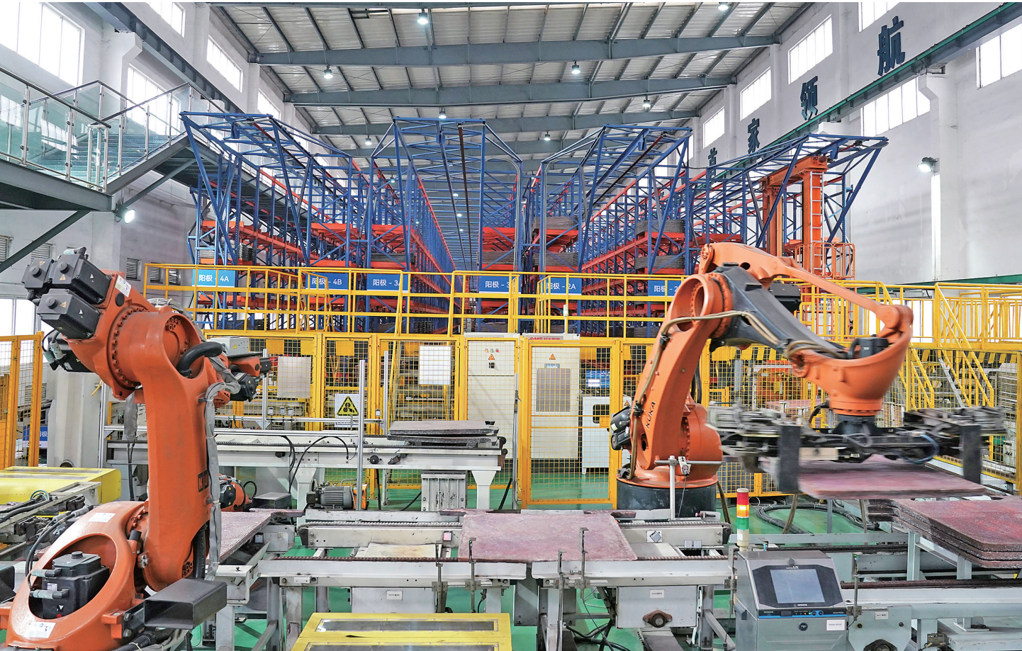
在江西铜业集团有限公司贵溪冶炼厂智能化电解车间，机器臂进行铜板转运作业。 新华社记者 万象 摄
