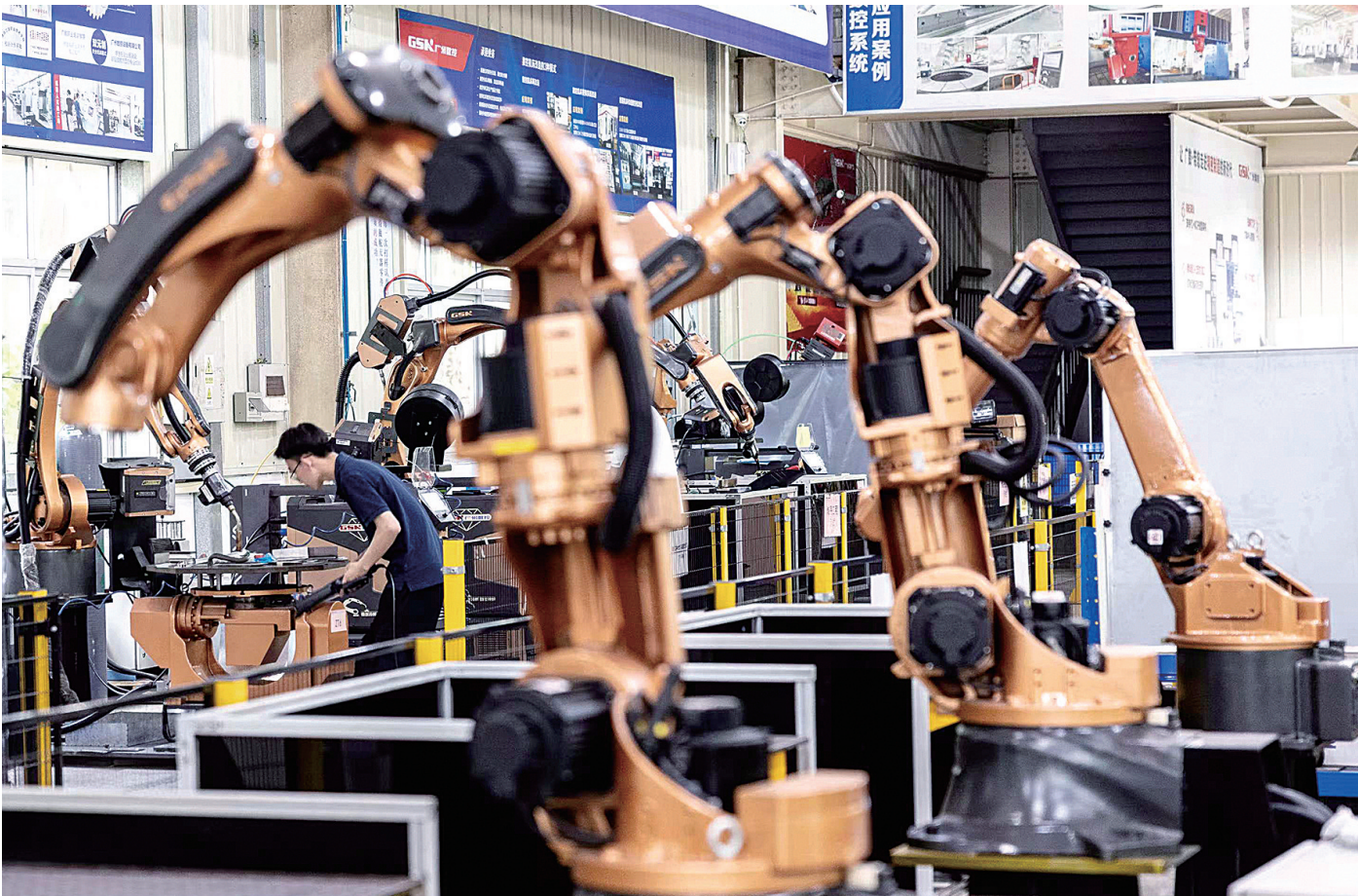
广州数控设备有限公司开发的国内首创、自有知识产权的600KG重载机器人。该机器人可广泛应用于搬运、焊接、码垛、装配及加工等重工业领域。
