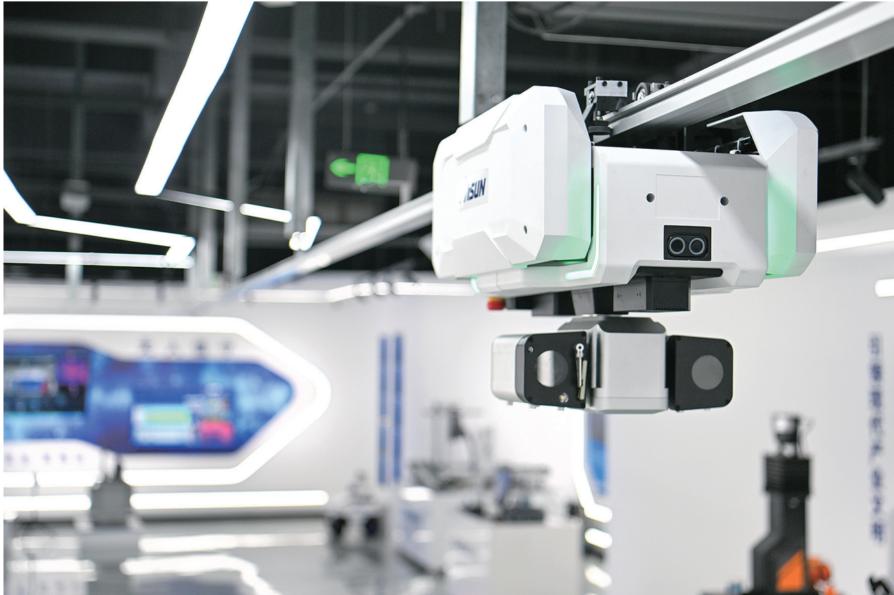
作为北京与天津携手贯彻京津冀协同发展战略的重点合作平台，京津中关村科技城自2017年正式破土动工以来，已累计注册经营主体1800余家，2024年税收同比增长13%，固定资产投资同比增长31.8%，规上工业产值同比增长62%。图为在位于京津中关村科技城的天津新松智能科技有限公司拍摄的一款轨道式无人值守机器人。
