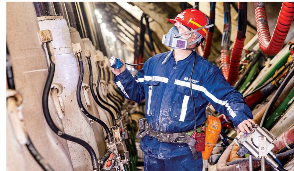
国家能源集团神东煤炭补连塔煤矿综采三队支架工认真检查工作面护帮板情况,确保设备正常运行。 刘长江 摄
