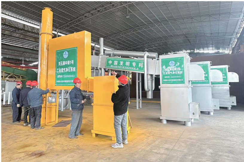
黄色精小型是全新亮相的“中铸一号”无负压气壳净化型。3台银亮色的是常规消失模负压烧空浇注用整装待发的“中铸一号”。
