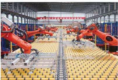
凯盛晶华800t/d特种玻璃生产线
