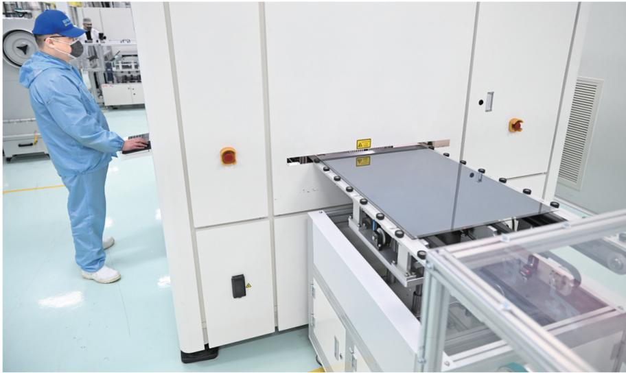
近年来,江苏省无锡市一批企业通过生产换线、人机协同、“上云用数赋智”等,打造智能工厂、智能车间,推动企业降本、提质、节能、增效,为制造业高质量发展提供新动能。图为在位于无锡市锡山区的极光电能有限公司智能生产车间,钙钛矿光伏组件正在自动化生产线上进行激光划刻工艺。
