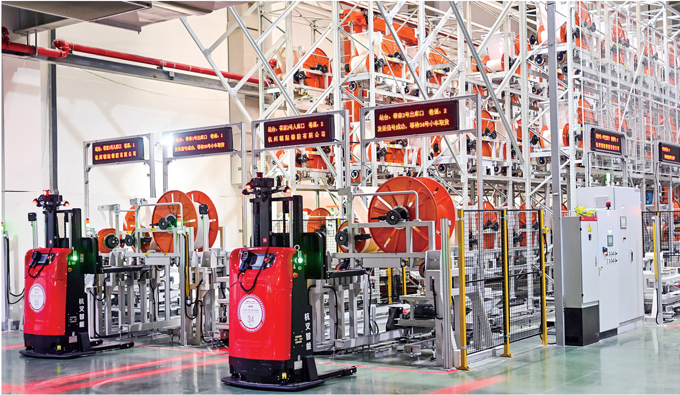
钱塘区是浙江省杭州市制造业产业较为集中的区域之一。近年来,杭州市钱塘区通过推进“专精特新”企业培育、推动制造业企业数字化改造、强化企业服务工作等方式,大力培育智能制造产业集群,推进实体经济与数字经济深度融合。图为无人叉车在杭州中策钱塘实业有限公司轮胎数字工厂车间内装运物料。 新华社记者 江汉 摄
