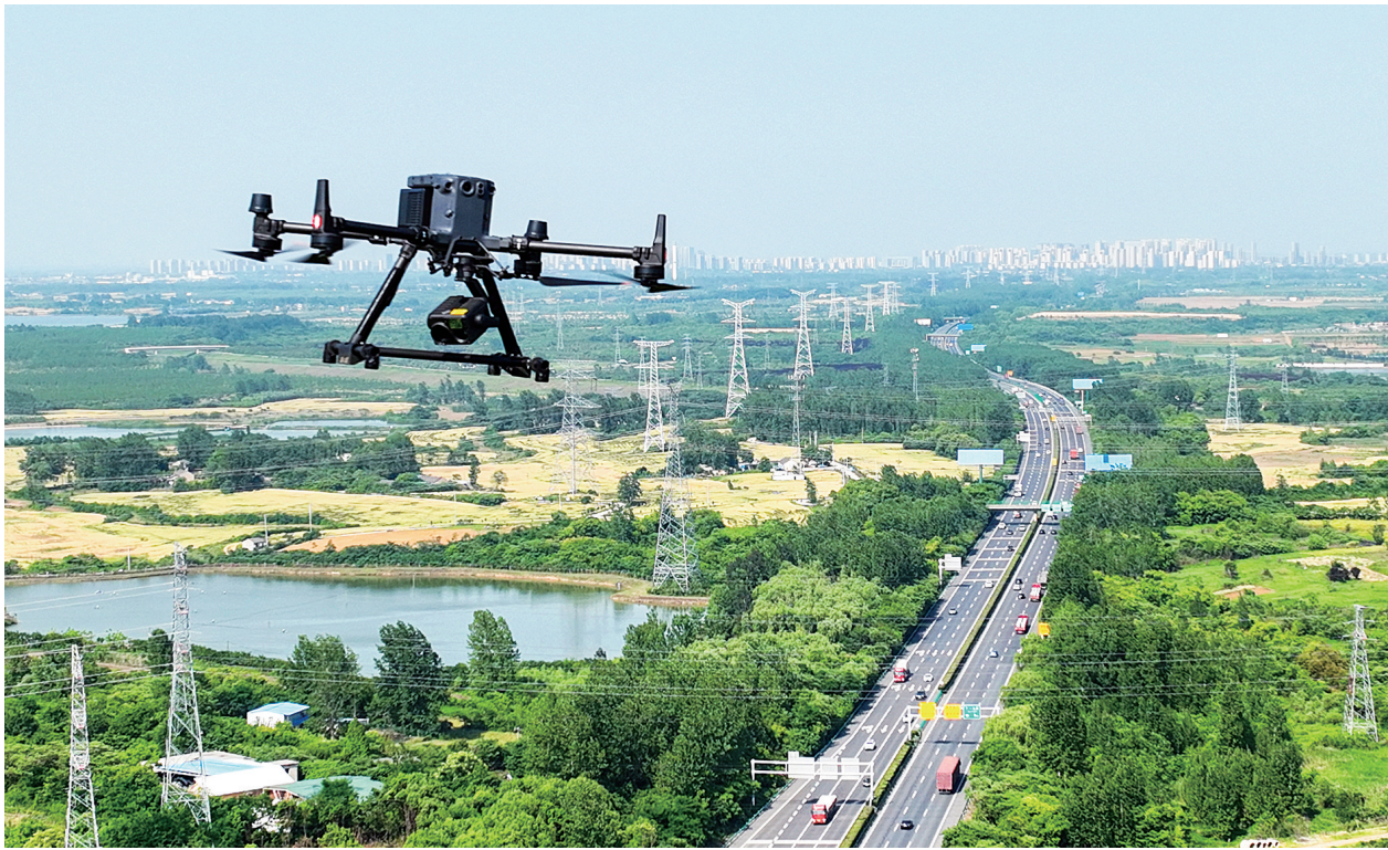
近年来,中部地区创新发展动能不断增强,山西、安徽、江西、河南、湖北、湖南等中部六省因地制宜,以科技创新引领产业创新,积极培育和发展新质生产力。图为一架无人机从中科安飞(合肥)科技有限公司自主研发的无人机自动机库起飞后,沿着预设路线进行路面巡检。
