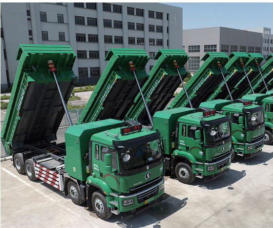
搭载康明斯 Accelera HD120 氢燃料电池的渣土车 (康明斯供图)
