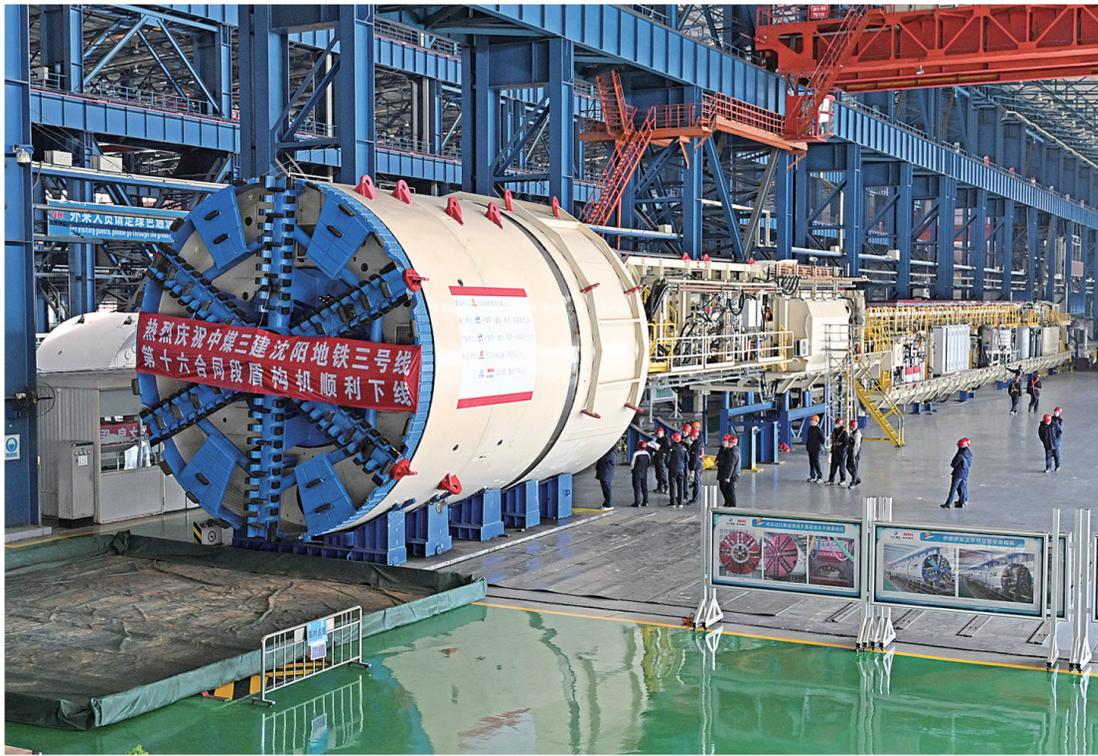
在推动大规模设备更新和消费品以旧换新政策带动下，一季度设备工器具购置投资同比增长17.6%。图为由北方重工生产的盾构机在车间顺利下线，工程技术人员对盾构机进行交付验收。
