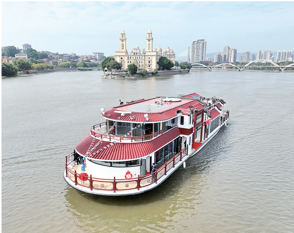
福建首艘自主设计建造的纯电动大型高端客船“闽江会客厅”近日在闽江首航。全船长度38.48米,型宽10.1米,能够载客212人,满载时最大航速达20km/小时,在观光航速航行下,其续航力可高达10小时。近年来,福建省持续推进“电动福建”建设,陆续出台系列支持政策,从试点示范项目、关键技术研究、充电设施建设等方面,推动电动船舶全产业链发展。图为“闽江会客厅”纯电动客船在闽江首航。
