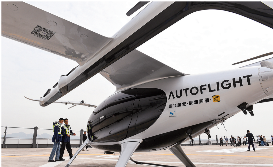
近日,5座eVTOL(电动垂直起降)航空器盛世龙从深圳蛇口邮轮母港起飞,20分钟后降落在珠海九洲港码头,完成航线首次演示飞行。“盛世龙”由峰飞航空科技自主研发,动力为纯电,巡航速度最高可达200公里每小时,最大续航里程250公里。
