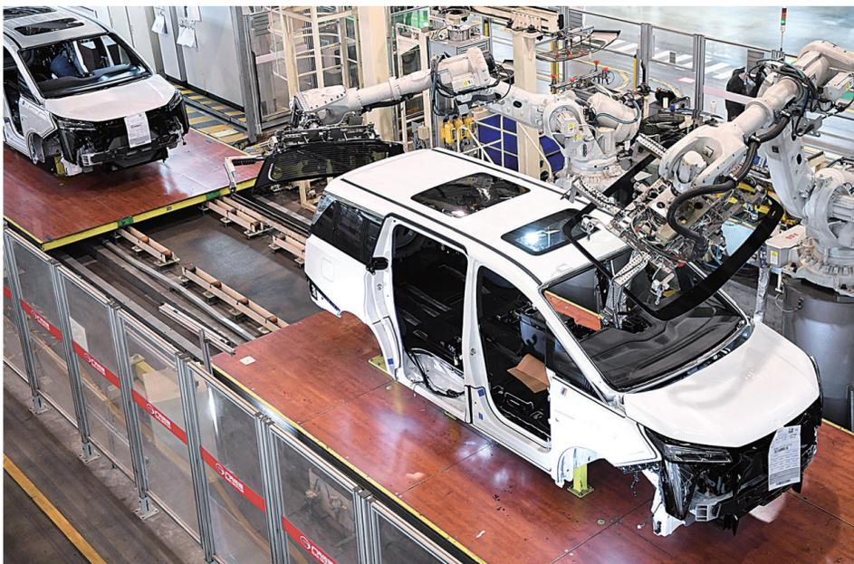
日前，在广汽传祺智慧工厂总装车间，机器人手臂在安装汽车玻璃。
