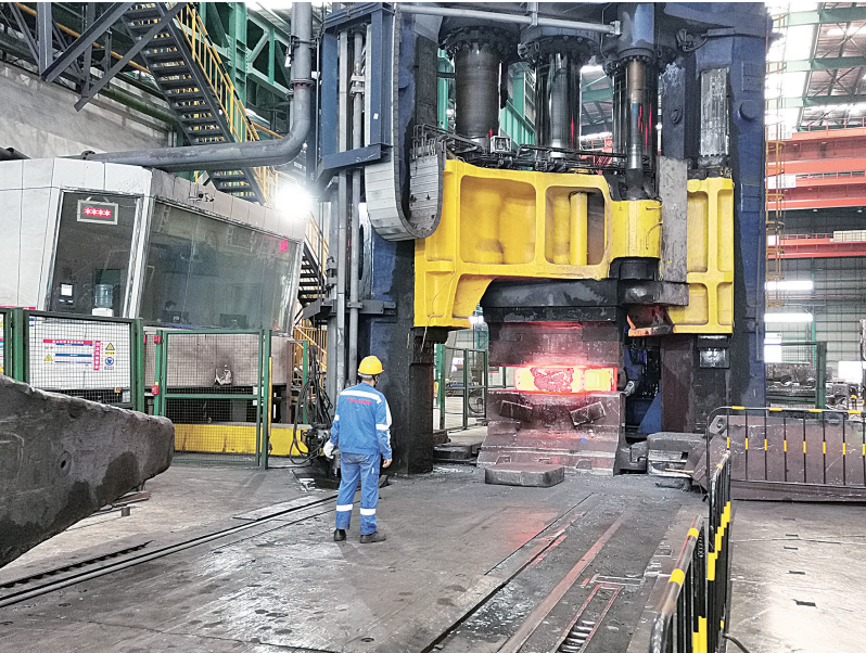
左图为李白纪念馆内的李白雕像。右图为四川六合特种金属材料股份有限公司引进的德国西马克公司6000T快锻机正在生产。
