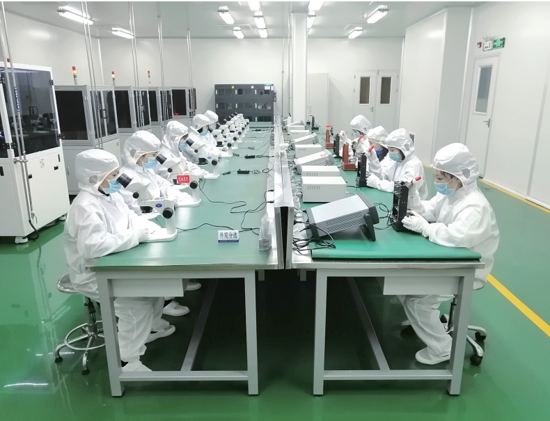
宏明宏科特种电容厂员工正进行外观分选作业
