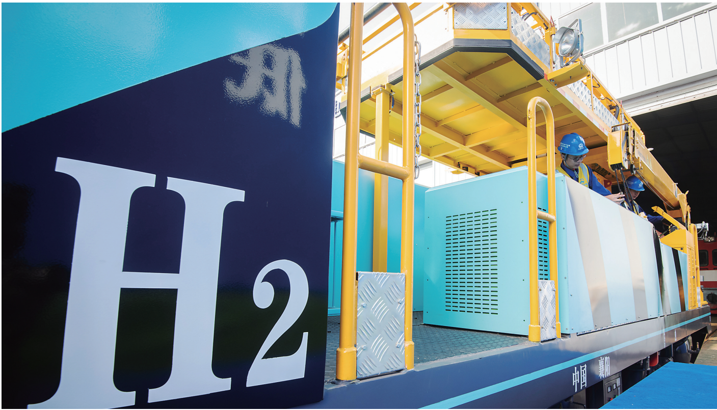
氢能源地铁施工作业车采用氢燃料电池与锂电池混合动力系统提供牵引动力,设计时速80公里。图为由中铁武汉电气化局研制的氢能源地铁施工作业车(资料图片)。
