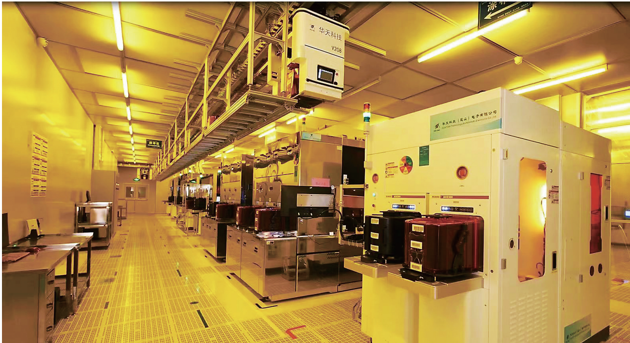
结合全新的制造执行系统，华天科技成为我国首家实现全工序自动传送、自动加工、自动检测、自动分析和判断的智能晶圆级封测工厂。
