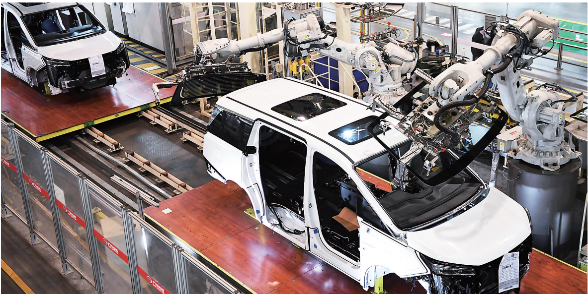
近年来,广东通过不断推进智能化、数字化改造走向制造业尖端。在工信部发布的智能制造示范工厂中,广东示范工厂的数量也居于全国前列。截至目前,广东规模以上工业企业达6.7万家、高新技术企业达6.9万家,均保持全国首位。世界一流的先进工厂、全国领先的工业设计能力、不断优化的产业结构……这些共同构成广东在推进高质量发展中勇当制造业“尖子生”的最新实践。图为在广州的广汽传祺智慧工厂总装车间,机器人手臂在安装汽车玻璃。
