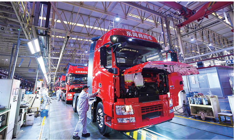
十堰东风商用车有限公司车辆生产装配线上,每两分钟就有一辆东风车下线。纪枫波 摄
