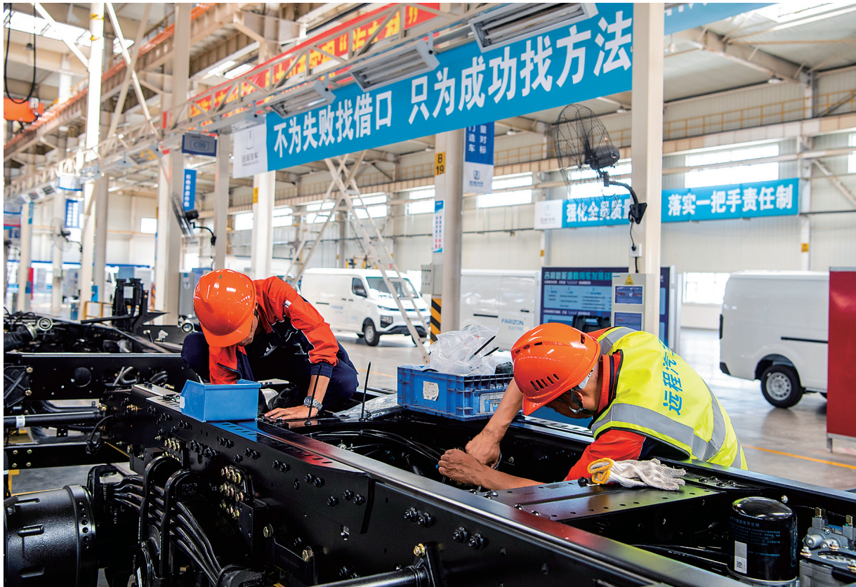
图为在位于山西省晋中市的山西新能源汽车工业有限公司(吉利晋中基地)总装车间内,工作人员在生产甲醇汽车。(资料图片)
