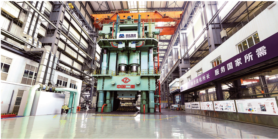
国机重装自主设计、制造、安装的世界最高等级8万吨模锻压力机（国机集团供图）
