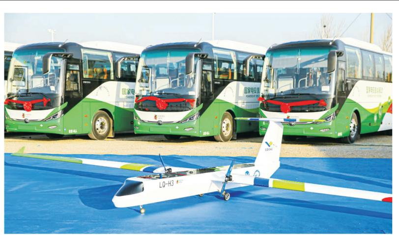
搭载国家电投集团氢能科技发展有限公司“氢腾”空冷燃料电池系统的无人机——灵雀-H
