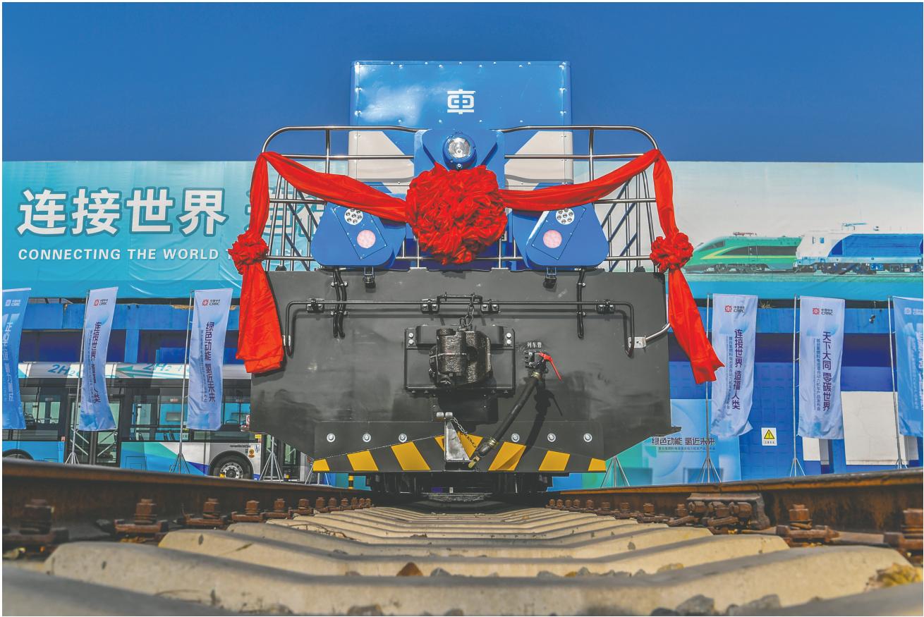
2021年1月27日,我国自主研发的首台氢燃料混合动力机车,在中车大同电力机车有限公司成功下线。此次下线的氢燃料混合动力机车设计时速达到每小时80公里,持续功率700千瓦,满载氢气可单机连续运行24.5小时,平直道最大牵引载重超过5000吨。(资料图片)
