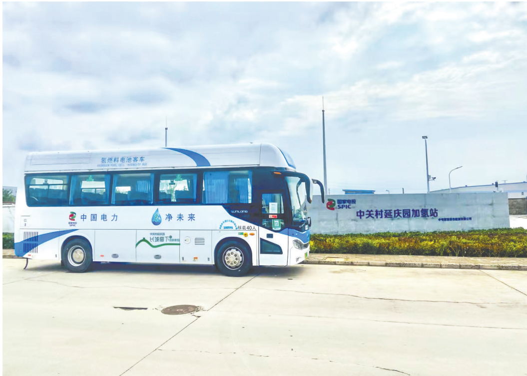
中国电力中关村延庆园加氢、充电站是2022年北京冬奥会闭环外交通基础设施,日加氢能力超过1000公斤(12小时计),每天能为60~80辆氢能大巴加满燃料。
