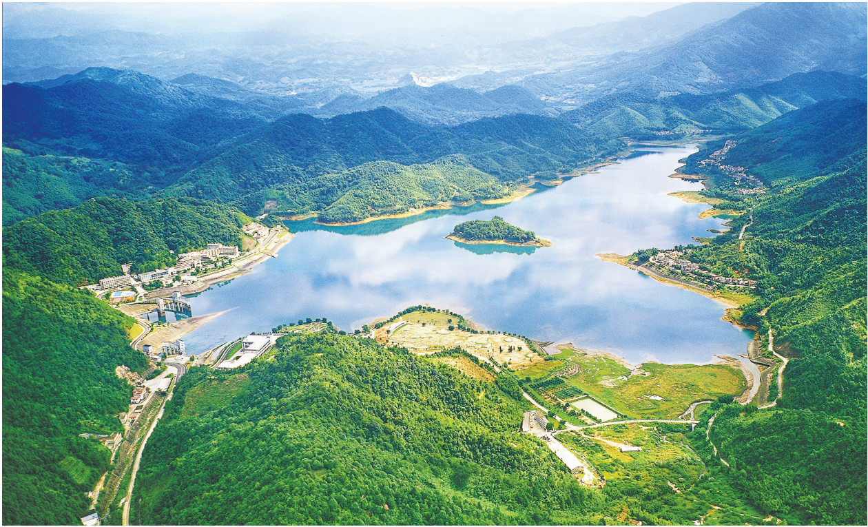
抽水蓄能电站承担着调峰、填谷、调频、调相、事故备用和配合新能源进行储能等多项任务，是构建新型电力系统不可或缺的重要部分。图为鸟瞰广州抽水蓄能电站下库。
