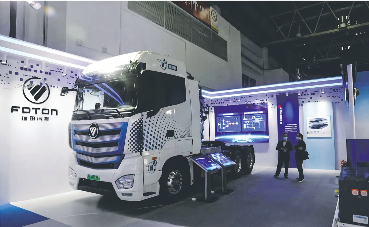
作为国内最早研发氢燃料电池商用车的企业,福田汽车已形成客车、轻卡、中卡、重卡全面布局。其中,智蓝欧曼氢能重卡搭载了大容量液氢系统,实际工况续航里程超过1000公里、标载49吨氢能,可满足重卡长途行驶需要,有效拓展了氢能重卡的应用场景。图为福田智蓝欧曼液氢重卡。(福田汽车供图)
