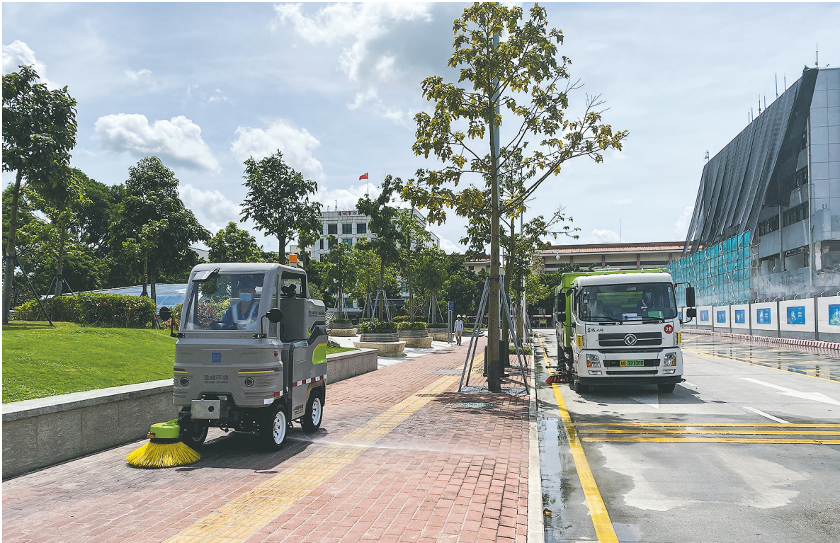
纯电动小型扫路机清扫人行道,纯电动18吨扫路车清扫主干道。
