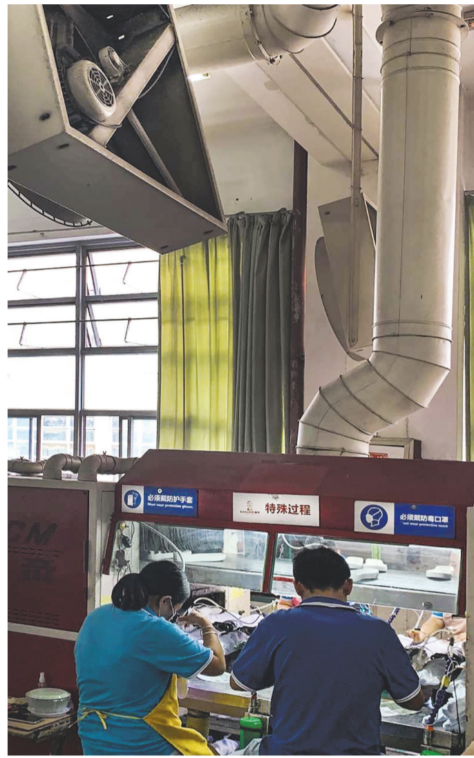
在鹿城区康奈集团制鞋车间,刷胶工人们都在一个专门收集挥发性有机物(VOCs)的方形罩子下进行操作,这种特殊材料制作的罩子,废气收集率达70%以上。
