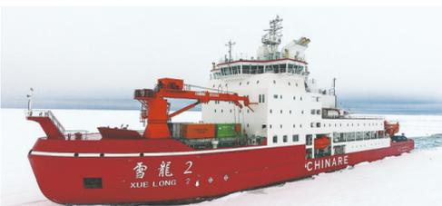
“雪龙2”号完成首向和尾向破冰试验
