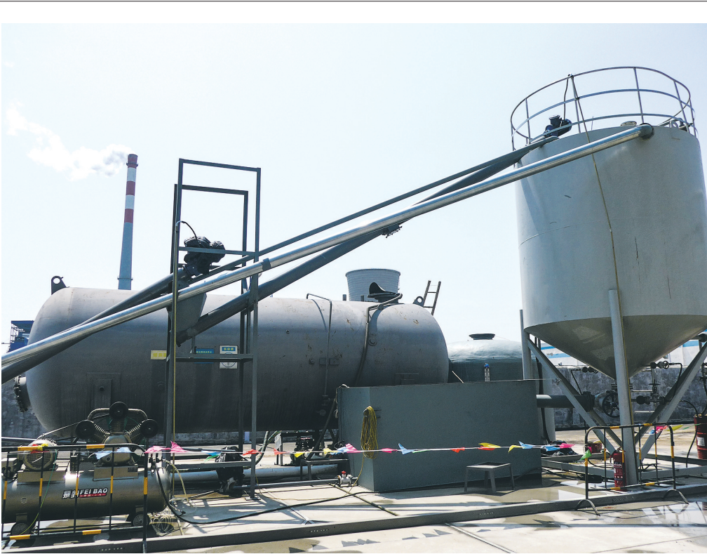
诗茵环保公司在处理含油污泥方面,拥有独立知识产权和自主创新能力。由他们研发的这套处理工艺,具有“设备相对简易,不需要高温加热(能耗低、安全隐患少),生产成本低、落地物无污染”的特点。图为该公司研发的新设备。
