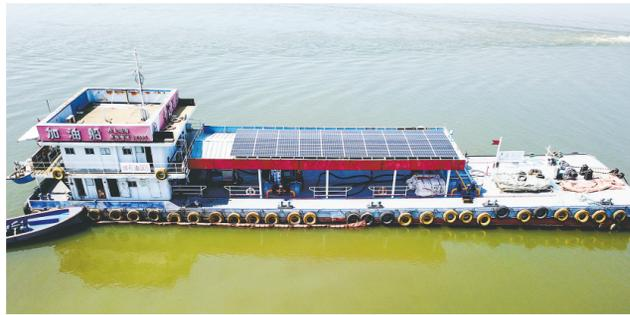
广东佛山的小塘加油船上清洁高效的光伏发电代替了传统的柴油机发电，不仅省钱，还减少了水质和大气的污染。（中国石化供图）
