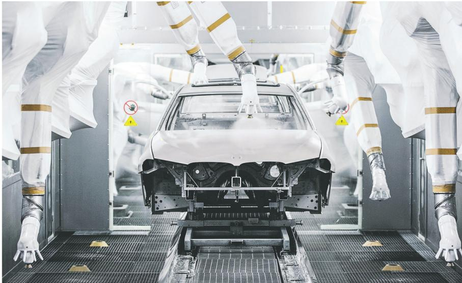
在沈阳华晨宝马大东工厂涂装车间，涂装机器人进行车身喷涂。
