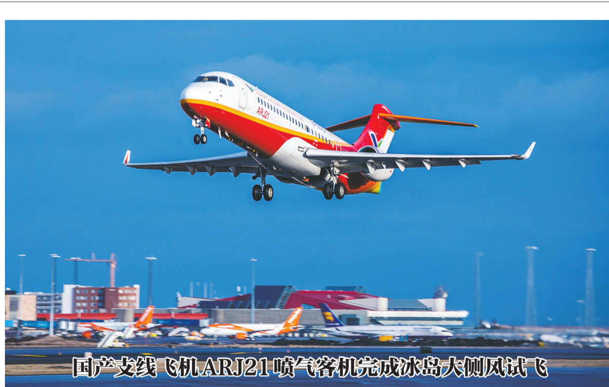
4月8日，由我国自主研发的ARJ21-700飞机104架试飞飞机平稳降落在西安阎良机场，为ARJ21-700飞机欧洲冰岛大侧风试飞之旅画上圆满句号。冰岛大侧风包线扩展审定试飞的成功，标志着ARJ21-700飞机具备适航规章要求的全部气象条件下的安全运营能力，对拓展飞机的运营环境、提高飞机的市场运营效率具有重要意义。图为ARJ21-700飞机104架机在冰岛凯夫拉维克国际机场进行试飞。
