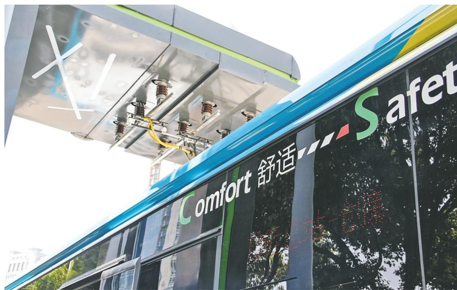
宁波中车产业基地全新研发的超级电容储能式现代电车正式投入公共交通运营。据悉,这种全新概念的公交车采用了目前世界上最先进的超级电容储能系统,车辆行驶路线不需要架设空中供电网,只需要在公交站点设置一个充电桩,30秒内就能充满电,行驶约5公里的路程。图为超级电容储能式现代电车正在进行充电。(资料图片)
