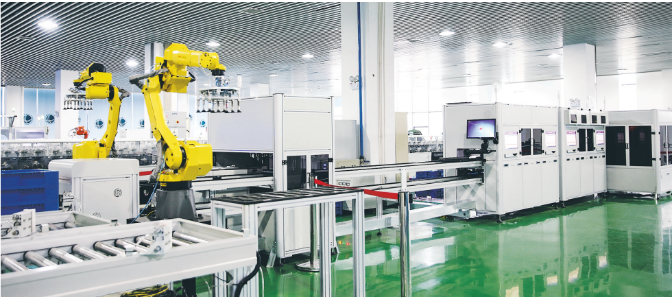
技术创新——国内首条智能表通信单元自动检测流水线
