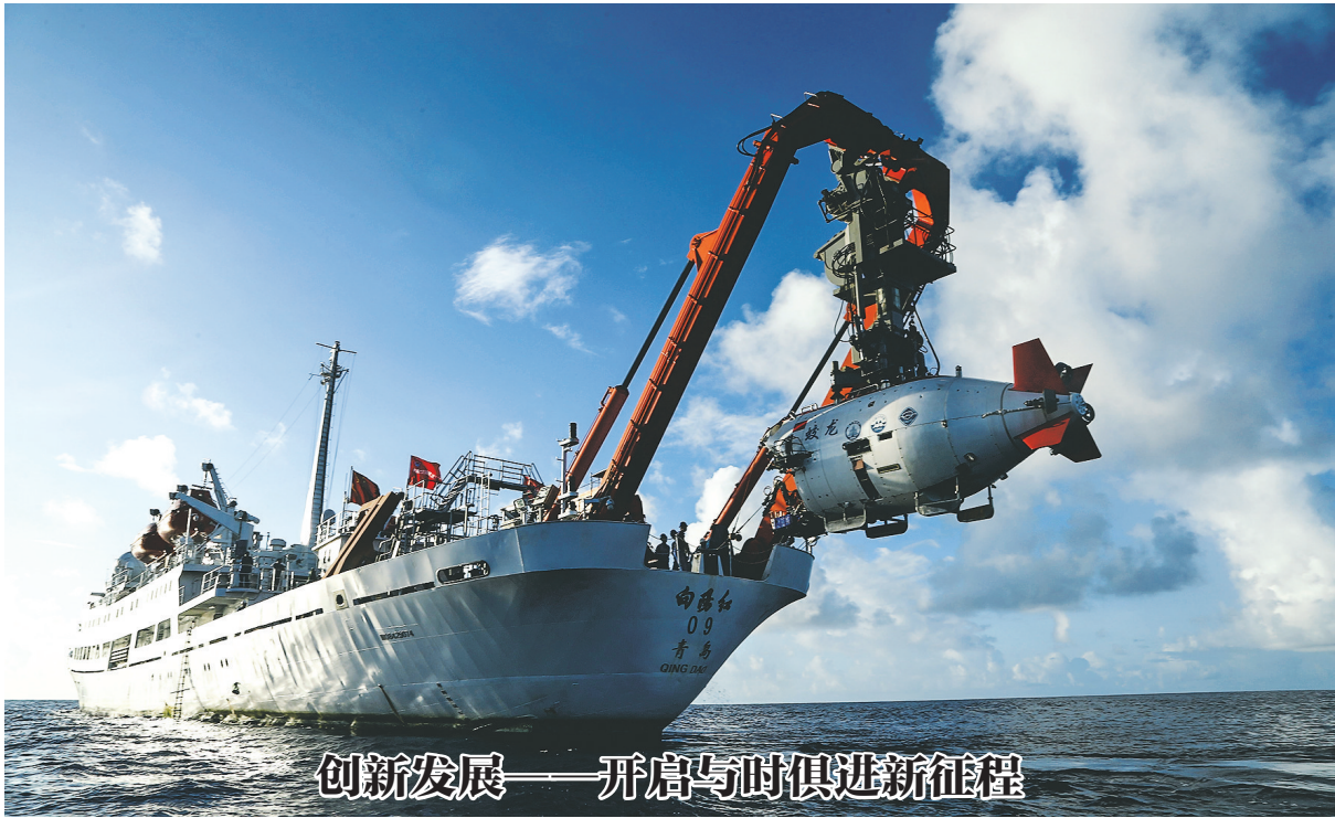
创新是引领发展的第一动力，是建设现代化经济体系的战略支撑。图为在马里亚纳海沟作业区，“蛟龙”号载人潜水器离开“向阳红09”科学考察船缓缓进入水中(资料图片)。
