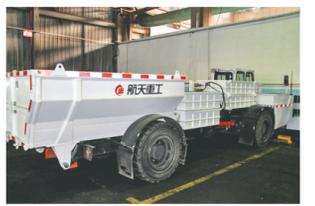
防爆锂离子无轨胶轮材料运输车
